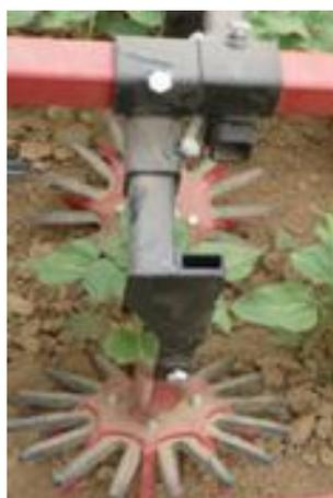
Il est possible de biner sur le rang sans utiliser un système de reconnaissance des plants. Des doigts souples (ou doigts Kress) sont alors placés sur les éléments bineurs et viennent biner le rang. Ce système est souvent utilisé en grandes cultures sur plantes sarclées (maïs, tournesol, colza, ...).
